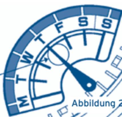
\* Wenn der Tagzeiger an einer Position wie in Abb. 1 anhält, drehen Sie die Krone sehr langsam im Uhrzeigersinn und stoppen Sie, sobald der Tagzeiger wie in Abb. 2 positioniert wurde.
