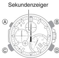
9. Drehen Sie die Krone, um den Sekundenzeiger an der 12-Uhr-Position auszurichten.
