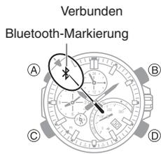
Wenn Sie (C) drücken, wird die Bluetooth-Verbindung beendet, und der Sekundenzeiger nimmt den normalen Betrieb wieder auf.
