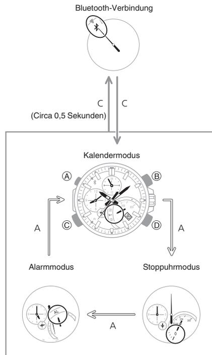
Verwenden Sie (A), um zwischen den Modi zu wechseln. Halten Sie (A) ca. zwei Sekunden lang gedrückt, um zum Kalendermodus zu wechseln. Für die Verbindung zu einem Handy halten Sie (C) ca. 0,5 Sekunden lang gedrückt.
