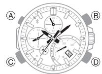
**Q2** Während eines schnellen Vorlaufs der Zeiger funktionieren die Tasten nicht.
