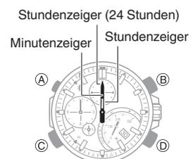
7. Drehen Sie die Krone, um den Stunden- und Minutenzeiger an der 12-Uhr-Position auszurichten.
