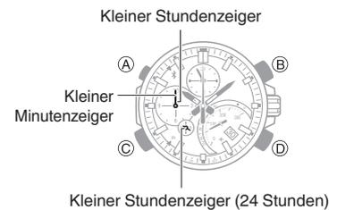
3. Drehen Sie die Krone, um den kleinen Stundenzeiger, den kleinen Minutenzeiger und den kleinen 24-Stundenzeiger auf 12 Uhr auszurichten.
