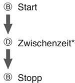
\* Bei jedem Drücken von (D) wird die verstrichene Zeit bis zu diesem Punkt (Zwischenzeit) 10 Sekunden lang angezeigt.
