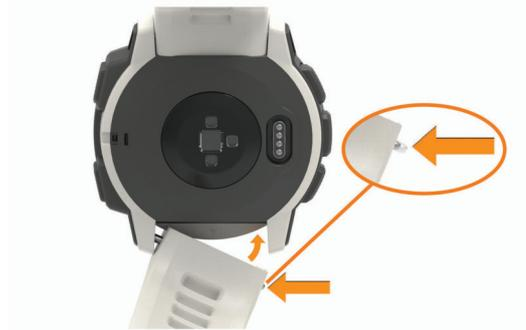
**HINWEIS:** Vergewissern Sie sich, dass das Armband sicher befestigt ist. Der Stift der Uhr muss auf die Löcher am Gerät ausgerichtet sein.
