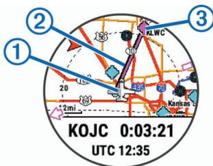
Auf der Karte werden die aktuelle Position ①, der zu verfolgende Track ② sowie das Ziel ③ angezeigt.
