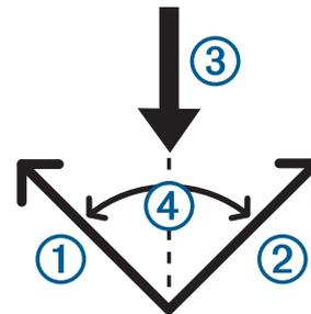
Anhand dieser Daten ermittelt das Gerät, ob sich das Schiff aufgrund einer Änderung der Windrichtung im Anluven oder Abfallen befindet.
