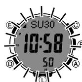
Für einfaches Ablesen im Dunkeln wird das Display der Uhr beleuchtet. Die Beleuchtungsautomatik der Uhr schaltet die Beleuchtung automatisch ein, wenn Sie die Uhr zum Ablesen auf das Gesicht richten.
